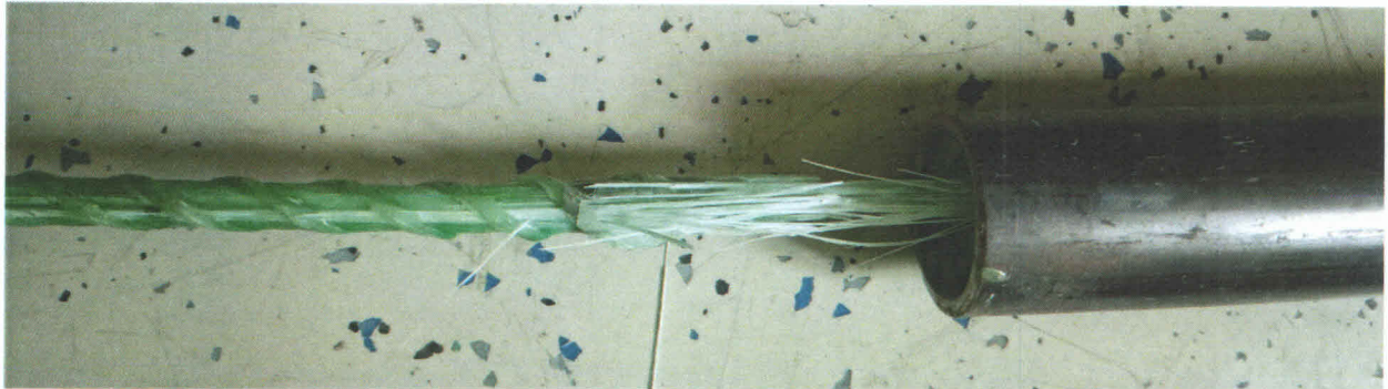
Слика 3: Изглед узорка по окончању испитивања
